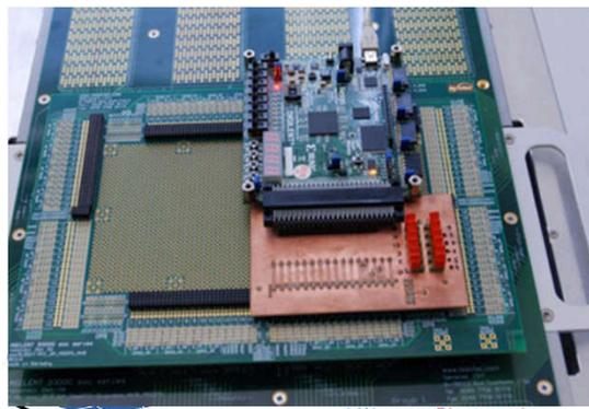
*Détection et diagnostic de pannes dans un circuit logique à l'aide du testeur industriel V93000 au pôle CNFM de Montpellier*
