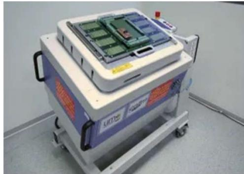
*Initiation à distance au test de circuits intégrés mixtes à l'aide du testeur V93000 au pôle CNFM PACA*
