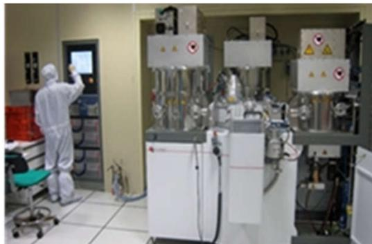
*Bâti de dépôt en salle blanche pour la réalisation de dispositifs haute fréquence au pôle CNFM de Lille*
