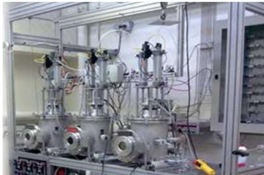
*Banc de dépôt de couches minces par PECVD pour l'électronique flexible du pôle CNFM de Rennes*
