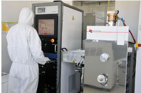
*Technologie microélectronique : canon à électrons pour dépôts de couches métalliques sur composants au pôle CNFM de Rennes*
